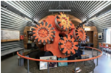
青函トンネルで活躍した「トンネル掘削機」(福島町トンネル記念館所蔵)
